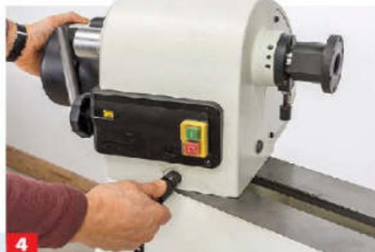
**4** Der Spindelstock kann auf dem Maschinenbett verschoben und für große Werkstücke um 360° geschwenkt werden.
