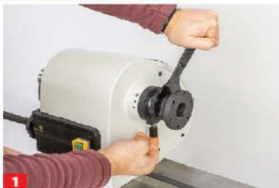
**1** Die Aufspannscheibe lässt sich mit der fest montierten Spindelarrretierung spielend leicht montieren oder abnehmen.
