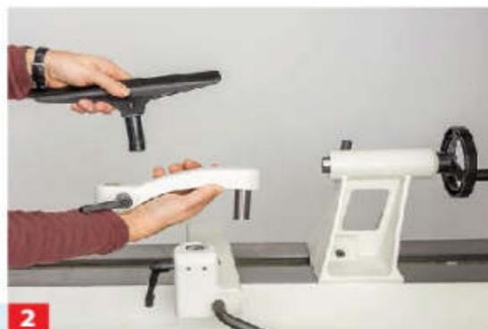
**2** Die Maschine wird mit Handstahlaufgabe und Ausleger geliefert – nützlich vor allem für Arbeiten mit geschwenktem Spindelstock.
