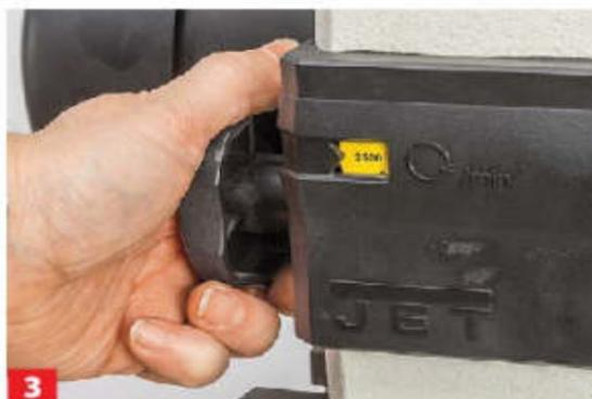
**3** Die Drehzahlen können einfach mechanisch per Handrad im Lauf zwischen 350 und 2500 min<sup>-1</sup> verstellt werden.
